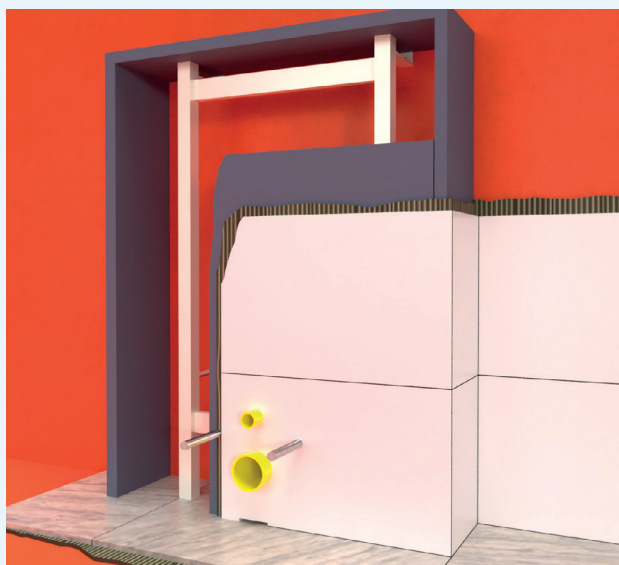
Tätskikt bakom inbyggd wc-stol med inbyggd vattenbehållare.
